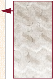
Znak wodny w papierze niewykazującym luminescencji w promieniowaniu ultrafioletowym (Watermarked Security „Vlnovky”-120g/m 2 )
